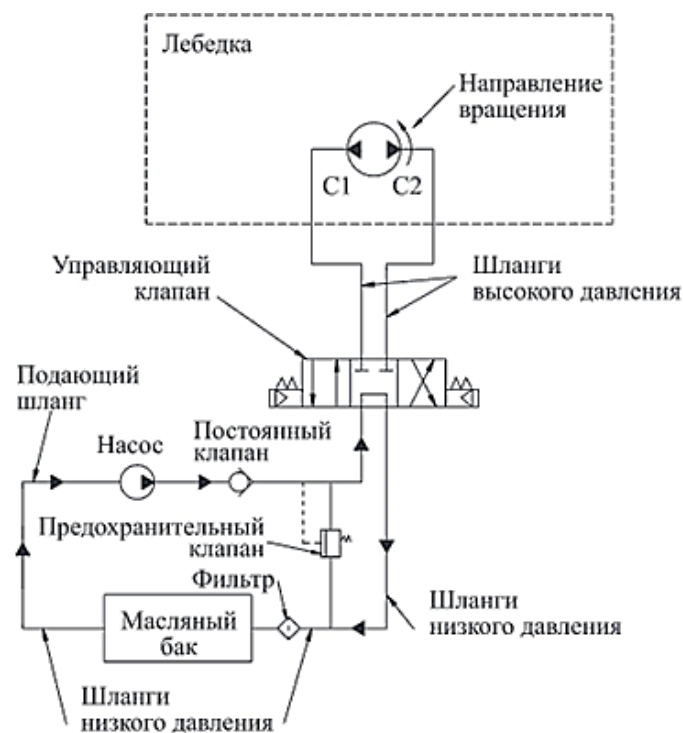
Рис. 1. Принципиальная гидравлическая схема возможного подключения гидравлической лебедки «Буйвол» ЛЧГ54И с червячным редуктором
